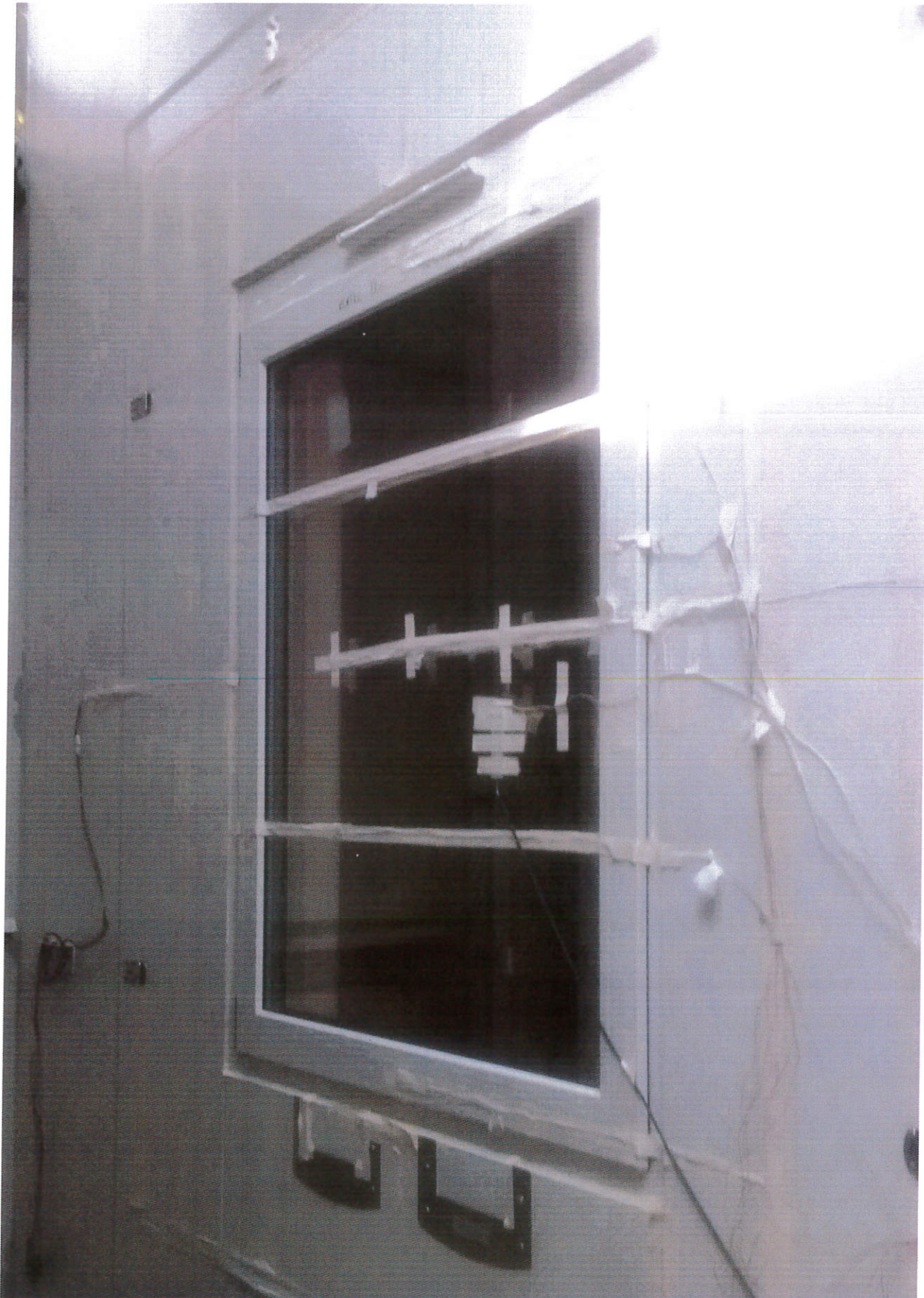
Rys. 3 Zdjęcie próbki po badaniu - okno PVC systemu Veka Softline 82 MD z zamontowanym nawiewnikiem VT 101 w profilu poszerzającym z kanałem łącznikowym KL (strona ciepła).
