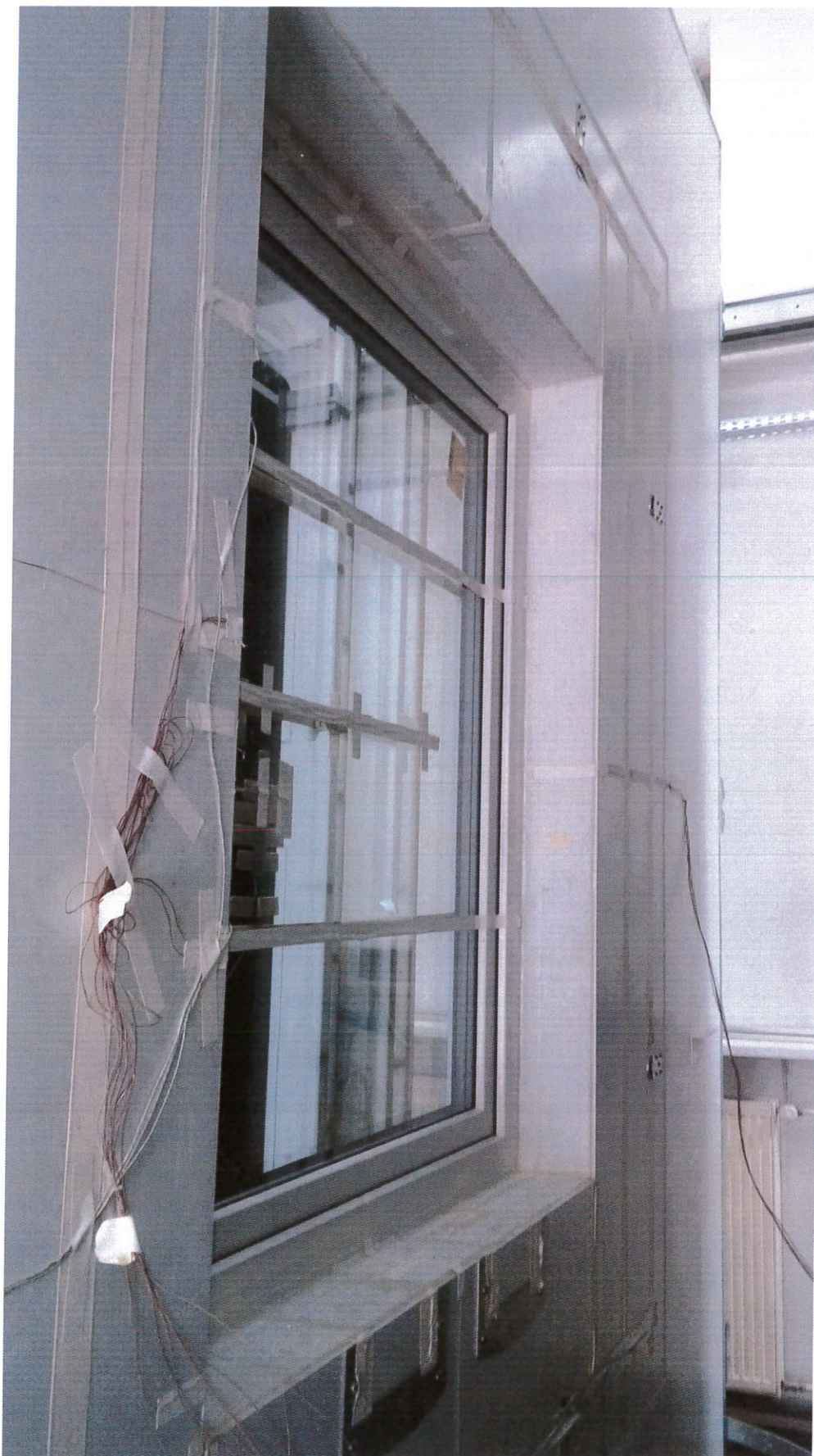
Rys. 2 Zdjęcie próbki po badaniu - okno PVC systemu Veka Softline 82 MD z zamontowanym nawiewnikiem VT 101 w przyłdzie okna (strona zimna).
