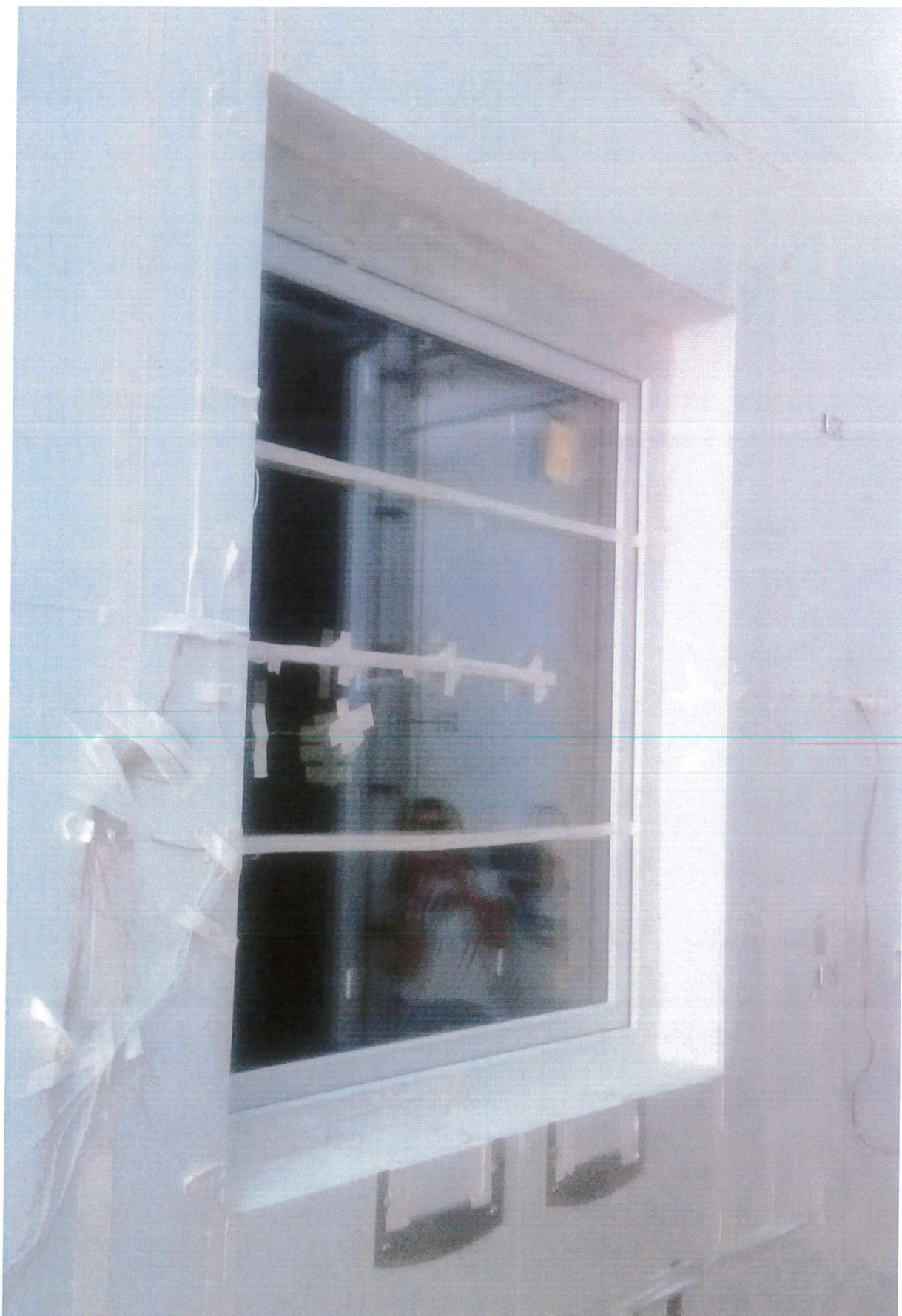
Rys. 4 Zdjęcie próbki po badaniu - okno PVC systemu Veka Softline 82 MD z zamontowanym nawiewnikiem VT 101 w profilu poszerzającym z kanałem łącznikowym KL (strona zimna).
